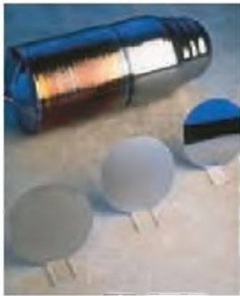
▲ Figura 22.43 Silicio elemental. Para fabricar dispositivos electrónicos, se funde silicio en polvo y se estira para formar un solo cristal mediante refinación por zonas (arriba). Se cortan del cristal obleas de silicio (abajo) y posteriormente se tratan mediante una serie de técnicas especiales para producir diversos dispositivos electrónicos.
